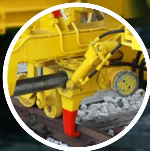
Como equipamiento complementario, la pinza combinada puede estar equipada de un cuadro de nivelación con grado de libertad. Este equipamiento facilita el enganche de la pinza en el corazón de los aparatos de vía.
