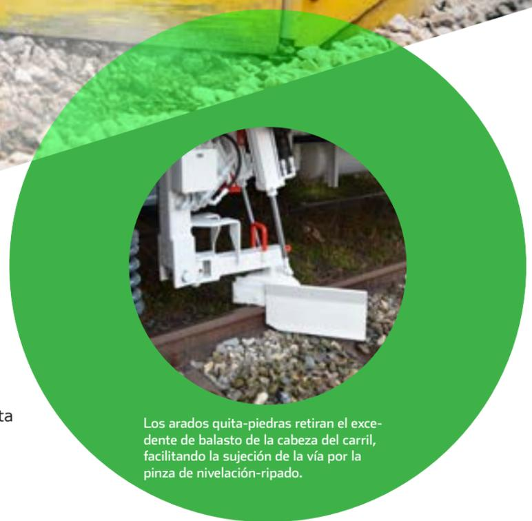
Los arados quita-piedras retiran el excedente de balasto de la cabeza del carril, facilitando la sujeción de la vía por la pinza de nivelación-ripado.
