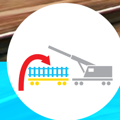
Carga del viejo desvío por medio de la misma grúa
