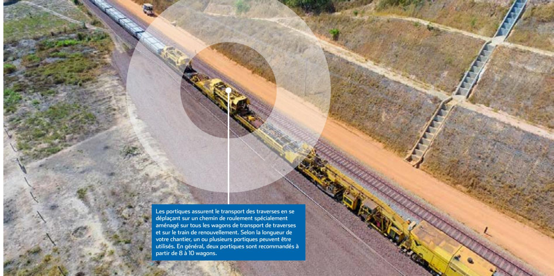
Les portiques assurent le transport des traverses en se déplaçant sur un chemin de roulement spécialement aménagé sur tous les wagons de transport de traverses et sur le train de renouvellement. Selon la longueur de votre chantier, un ou plusieurs portiques peuvent être utilisés. En général, deux portiques sont recommandés à partir de 8 à 10 wagons.
